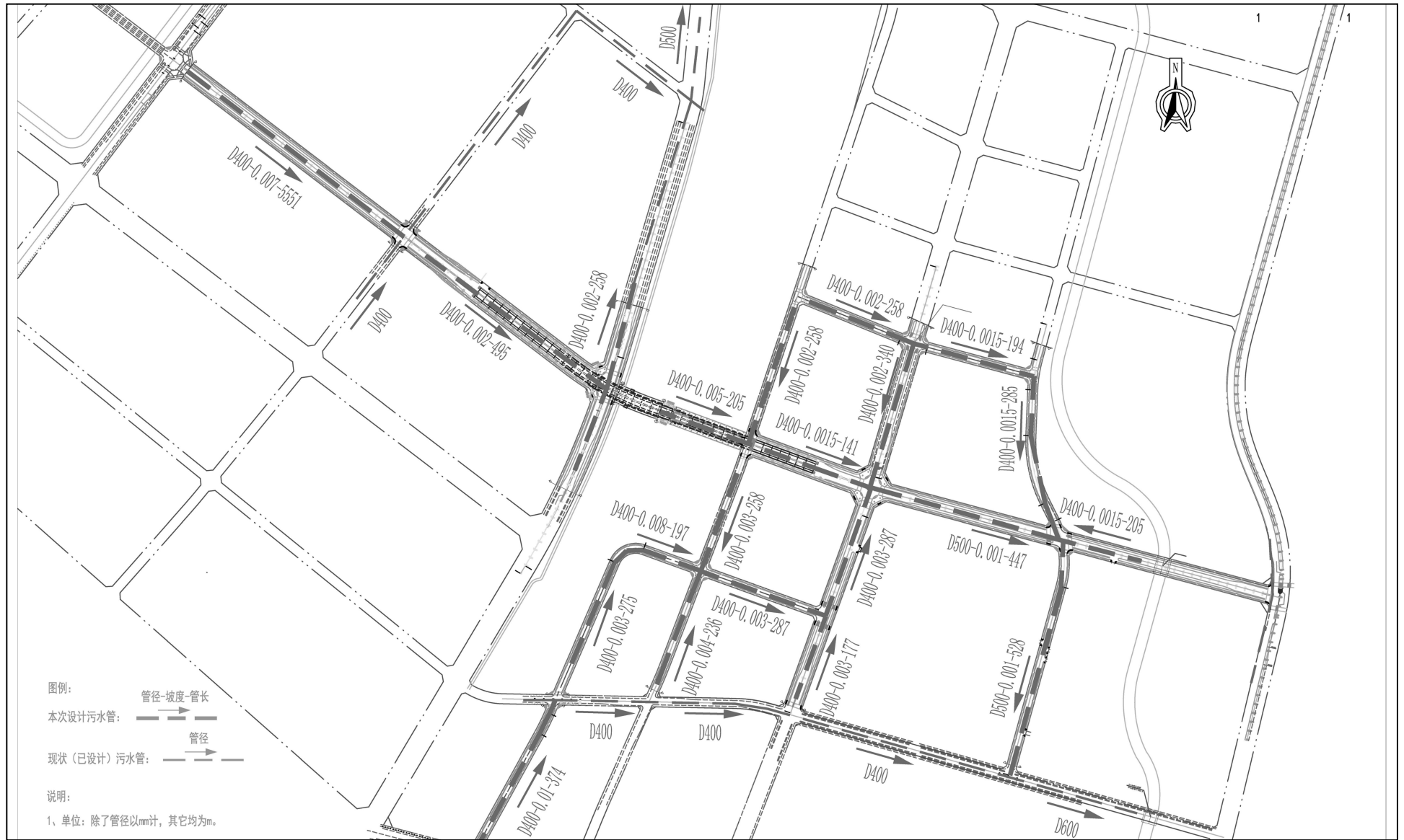
附图 5 污水管线布置图
