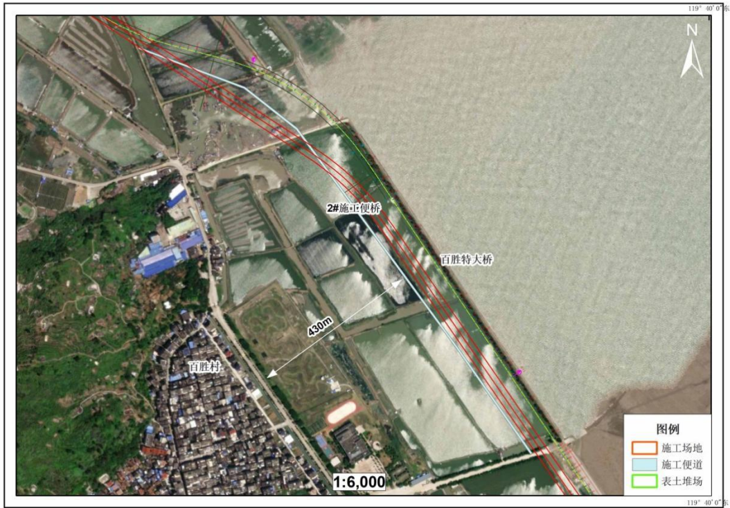
图 3.4-20d 临时工程平面布置示意图（2#施工便桥）
