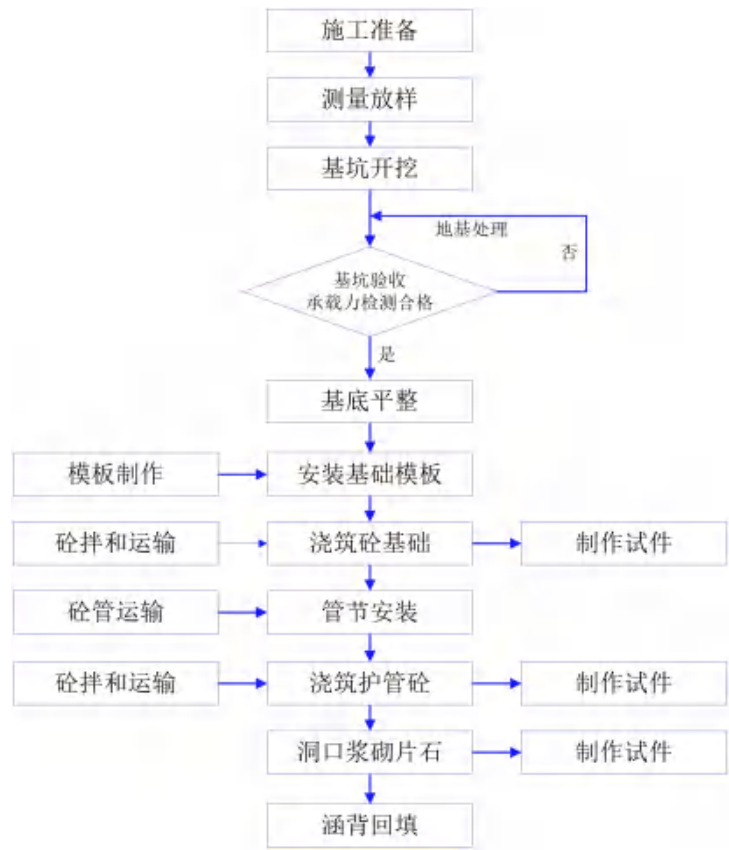
图 3.5-8 圆管涵施工工序流程图
