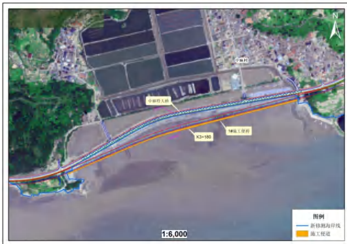
图 3.5-31c 临时工程平面布置示意图（1#施工便桥）
