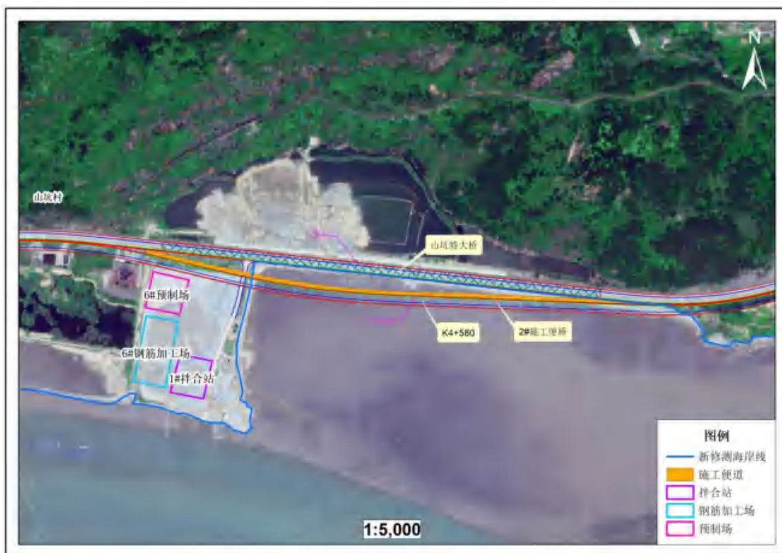
图 3.5-31d 临时工程平面布置示意图（2#施工便桥）
