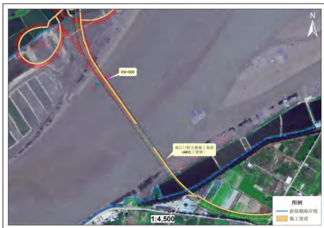
图 3.5-31g 临时工程平面布置示意图（4#施工便桥）
