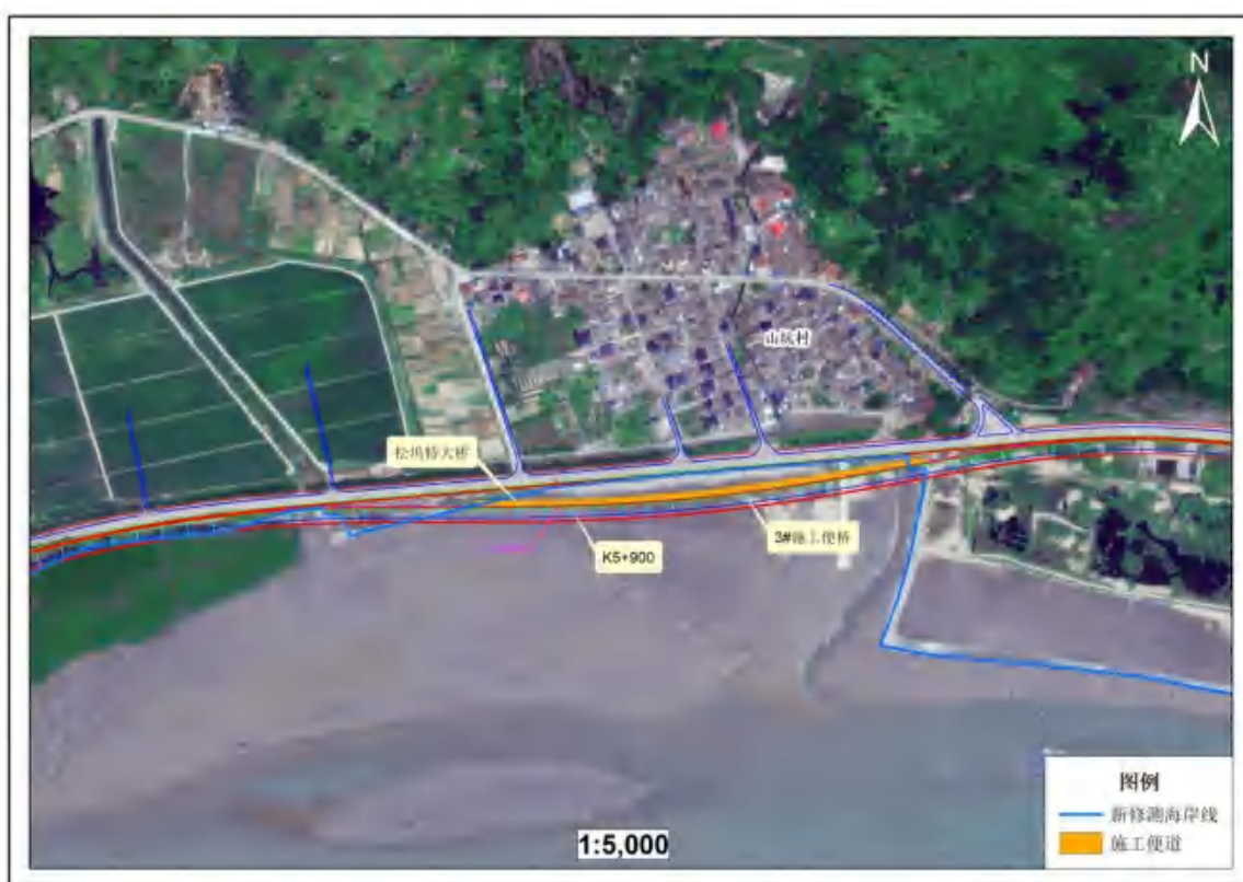
图 3.5-31e 临时工程平面布置示意图（3#施工便桥）
