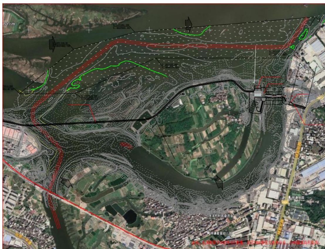
图 3.1-3 施工期通航临时通道示意图
