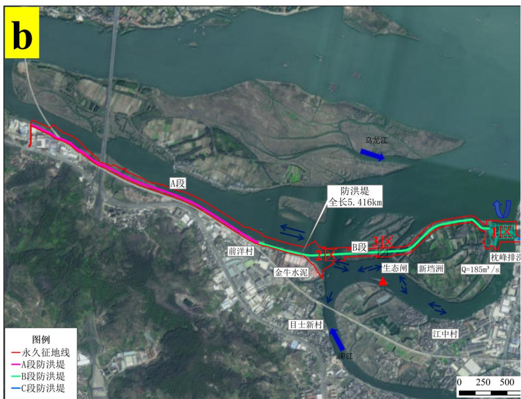
图 5.3-3 施工 1 区（枕峰水闸）围堰施工期水流方向（b）
