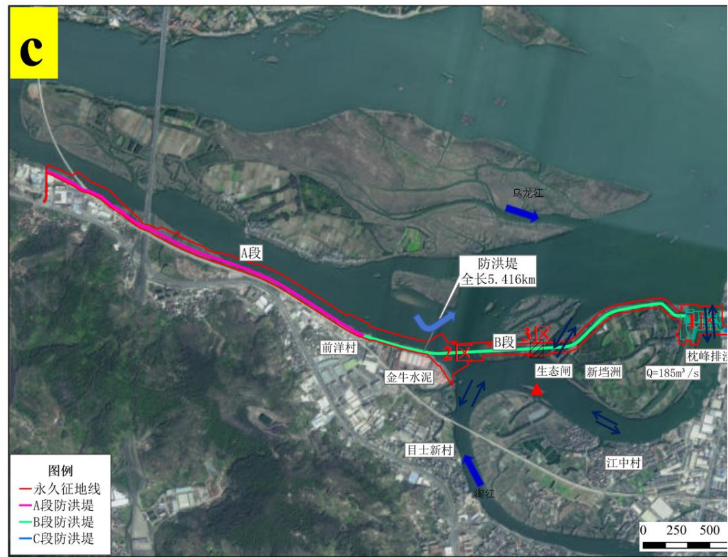
图 5.3-4 施工 2 区施工期（连通闸）水流方向（c）
