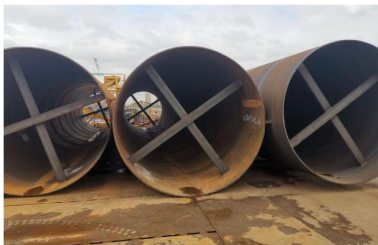
图2.10-7 水中钢护筒十字支撑箍设置示意图
