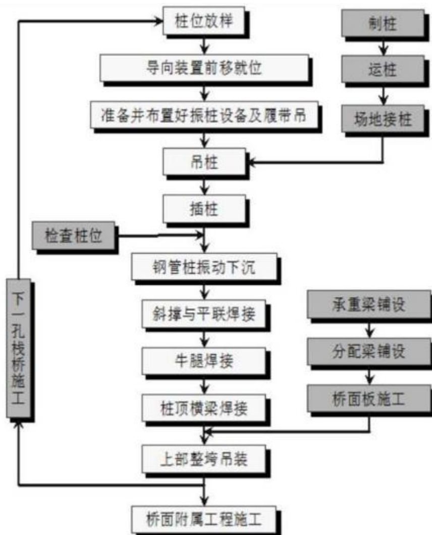
图 2.10-5 施工钢便桥工艺流程图
